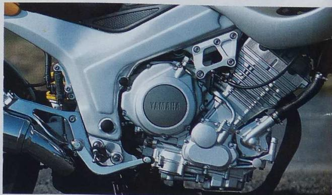
Vpřed skloněný kapalinou chlazený řadový dvouválec disponuje optimálním výkonem 59 kW/7 500 1/min.
