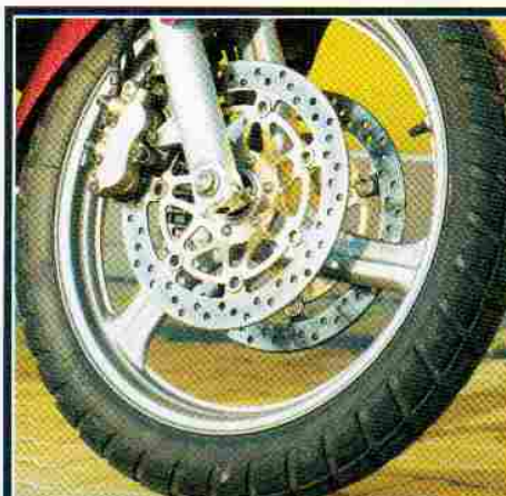
Tak tohle snad nikomu nemusíme představovat. Třípístkové třmeny a systém Dual CBS.
